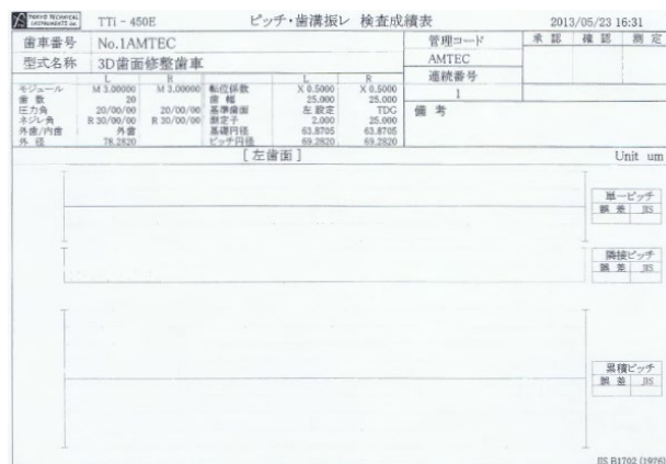
図 104.9 検査結果 (ピッチ誤差, 左歯面)
